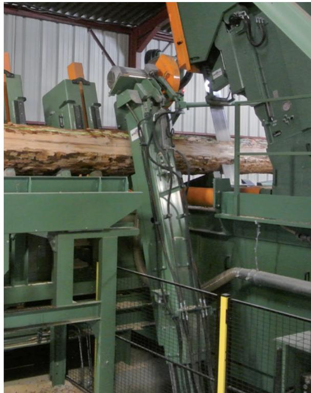
Installiert vor dem Sägeständer, für Kappung und Vor-Besäumung von Schwarten und anderen Produkten, Schnittstärke bis 150 mm.
